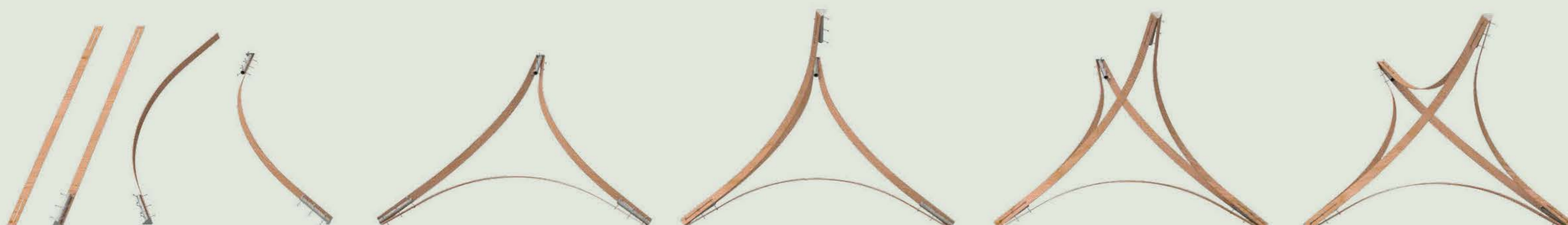
Secuencia montaje estructuras
